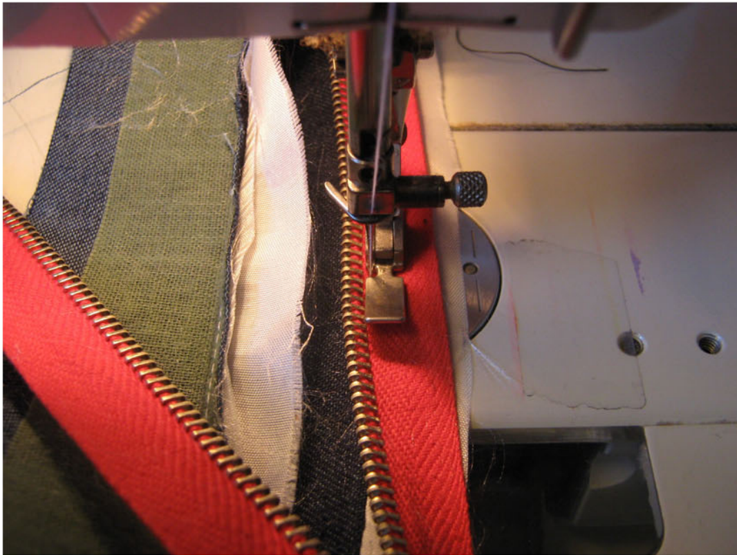
Foto 3a Leg de bovenkant van een ritshelft op de zaklijn van de zakstrook, de tandjes wijzen naar de buitenrand en laat de rits naar voren sluiten. Stik ritshelft vlak langs de tandjes, eventueel met een ritsvoetje, op de zakstrook vast.
